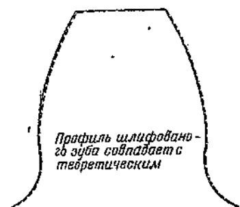
Фиг. 98. Правильный профиль шлифованных зубьев.
