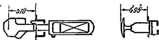
Рис. 18. Установка автосцепки при сечении буферного бруса из двух зетов.
