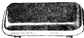
Фиг. 14. Башмак с резиновой накладкой „Катерпиллер“.
