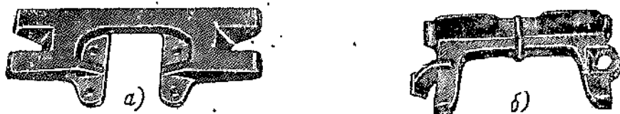
Фиг. 12. „Скелетообразный“ башмак для снега и шпора „Катерпилер“.
