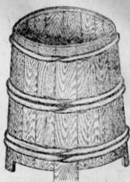
Рис. 5. Кадка на ножках из древесины хвойных пород с деревянными обручами
