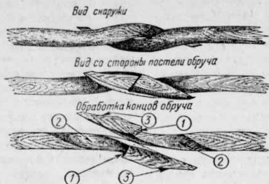
Рис. 25. Замок деревянных обручей: 1—за- рубки, 2—выемки, 3—срезы концов обруча
