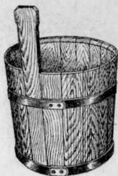
Рис. 11. Шайка из древесины хвойных пород с железными обручами
