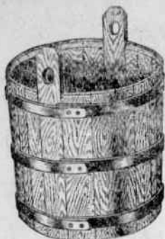
Рис. 8. Ушат из древесины хвойных пород с железными обручами
