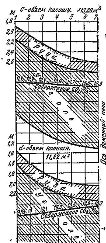
Фиг. 188. Схема расположения угольной и рудной колош при засыпном аппарате ю.-уральского типа после переделки на доменной печи № 2 Ачинского завода по данным УИМ.
