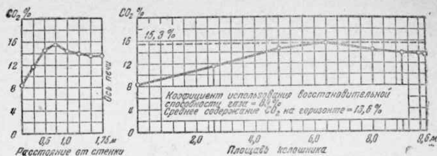
Фиг. 172. Содержание углекислоты на доменной печи № 3 Чусовского завода.
