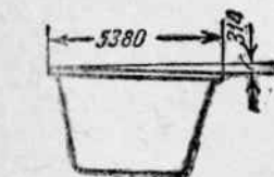
Фиг. 136. Перекос колошника доменной печи Магнитогорского завода.
