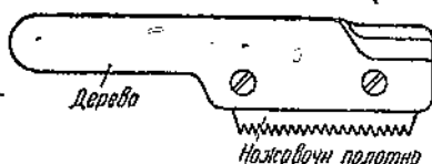
Ф и г. 195. Скребок для удаления слюдяных прокладок между медными пластинами коллектора.
