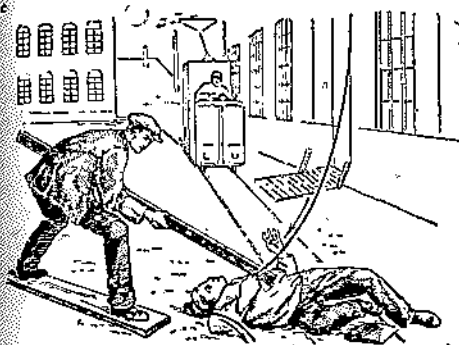
Фиг. 228. Отделение провода с током от пострадавшего.
