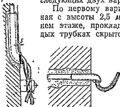
Ф и г. 85. Правильная установка фарфоровой воронки. а — в сухом; б — в сыром помещении и на воздухе.
