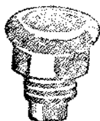
Ф и г. 32а. Пробка к предохранителю пробочному закрытому (фиг. 28).
