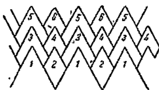
Рис. 49. Профиль стружки для ножей Голлера
