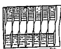
Рис. 89. Схема движения воды в диффузионном аппарате Берже
