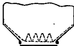
Рис. 82. Нижнее сито диффузора с гребнями по ЦИНСу
