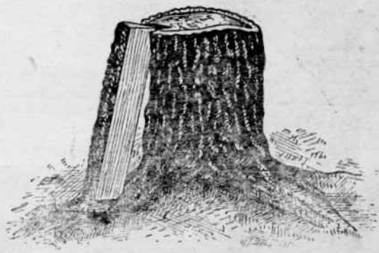
Рис. 18. Положение кола при теске в «пне»
