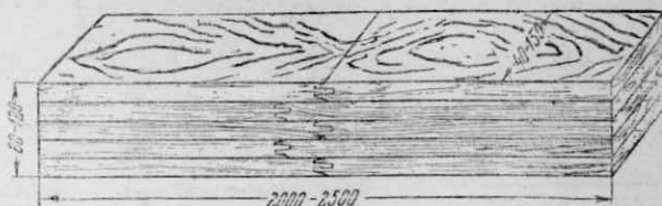
Рис. 6. Блок, склеенный из планок
