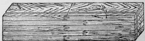
Рис. 9. Распиловка блока на пластины
