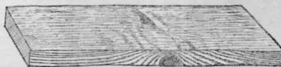
Рис. 13. Положение сука в клепке при выходе с кромки на плась
