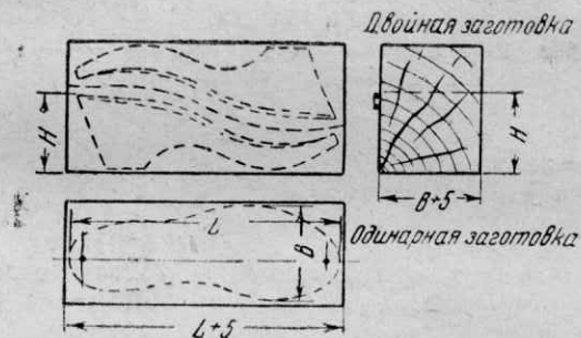
Рис. 5. Выкраивание подошв из заготовки двойной толщины
