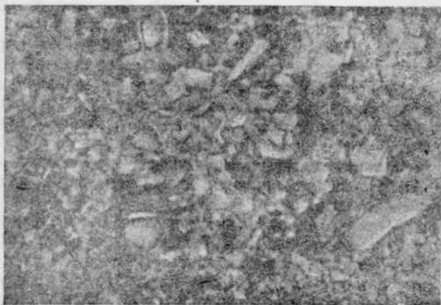
Фиг. 12. Типичная микроструктура титано-вольфрамового сплава. Увел. 1000.
