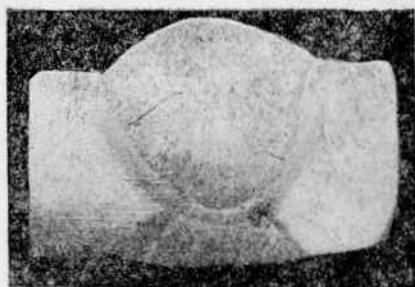
Фиг. 49. Трещины в шве около сульфидных строчек.
