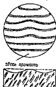
Рис. 137. Испытание качества полированной поверхности пробным стеклом
