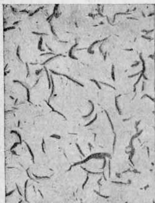
Рис. 14. Микроструктура чугуна „большевик“; a —не травлен, ув. 130; б —травлен азотной кислотой, ув. 130.
