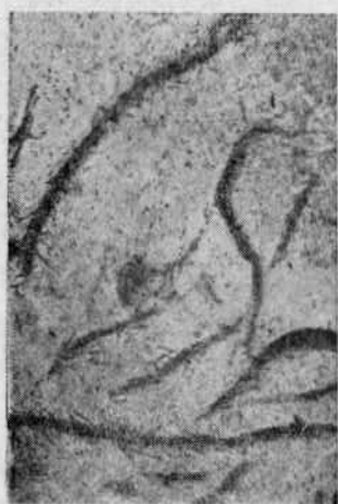
Рис. 12. Образование графитных пластинок из графитной эвтектики: a —ледебурит, графитная эвтектика и графитная пластинка, травлен пикратом натрия, ув. 640; б —начало образования графитных пластинок в графитной эвтектике, не травлен, ув. 640; в —образование графитных пластинок в эвтектике, травлен пикратом натрия, ув. 640; г —процесс образования графитной пластинки, не травлен, ув. 2000; д —процесс образования графитной пластинки, приближающийся к концу, травлен пикратом натрия, ув. 1500; е —графитные пластинки, не травлен, ув. 1500.
