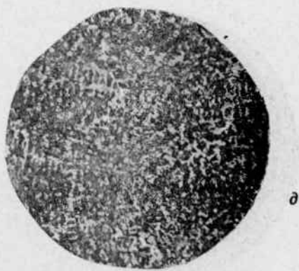
Рис. 2. а—не травлен, ув. 100х; б—не травлен, ув. 100х; в—травлен 4% \text{HNO}_3 , ув. 300х; г—травлен реактивом Стэда-ле-Шателье, ув. 18х; д—травлен реактивом Стэда-ле-Шателье, ув. 18х. Без присадки.
