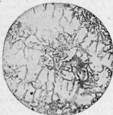
Рис. 6. Расположение глобул графита между ветвями кристаллов гамма-железа.
