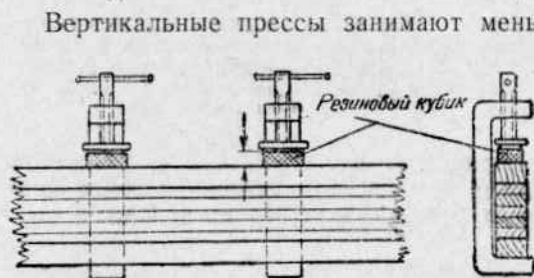
Фиг. 79. Проверка давления при винтовой запрессовке с помощью тарированных резиновых кубиков.
