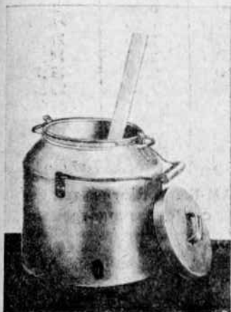
Фиг. 23. Бачок для приготовления клея вручную с охлаждением стенок бака водой.
