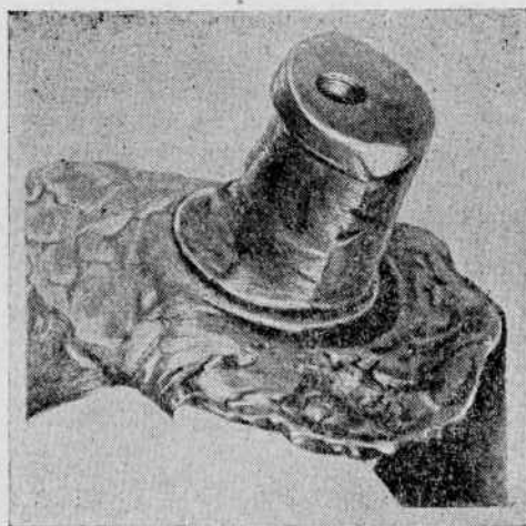
Фиг. 74. Износ шипа крестовины кардана.
