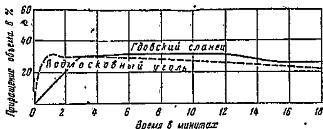
Рис. 21. Набухание подмосковного угля и сланца в спирто-бензоле
