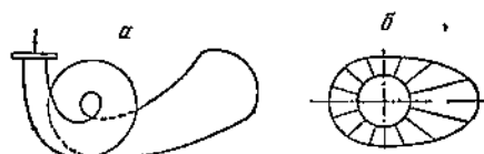
Фиг. 231. Характер движения пылепотока при тангенциальном подводе первичного воздуха.
