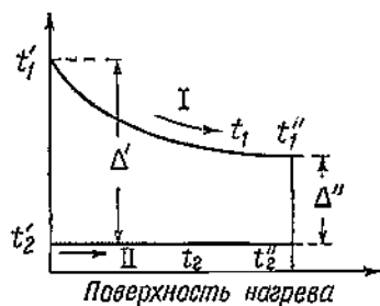
Фиг. 38. Диаграмма изменения температур греющего и нагреваемого тел при постоянстве одной или обеих температур.
