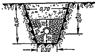
Рис. 35. Укладка дрен в суглинках.
