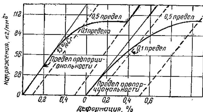
Фиг. 99. Типичная кривая «напряжение — деформация» для термически обработанной стали с содержанием 0,16% углерода и 13% хрома и для холоднокатаной стали 18-8, содержащей 0,12% углерода [357]
