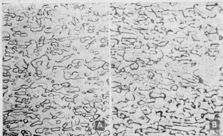
Фиг. 125. Структура (аустенит и феррит) после горячей обработки (ковки) стали, содержащей 0,07% углерода; 19,6% хрома; 9,08% марганца, 0,36% кремния и 0,90% меди: А — закалка в воду с 1050°; В — охлаждение на воздухе, с той же температуры, \times 250
