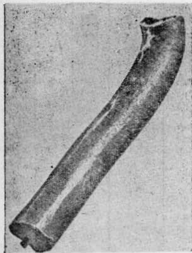
Фиг. 111. Влияние интеркристаллитной коррозии на излом стали 18-8. Обратит внимание на здоровую сердцевину металла (частное сообщение Гатфильда)
