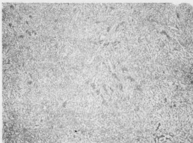
Фиг. 70. Структура чугуна, содержащего 2,33% углерода, 14,75% хрома и 4,43% кремния. Высокое содержание кремния вызвало появление хрупкого кремнехромистого феррита, \times 100
