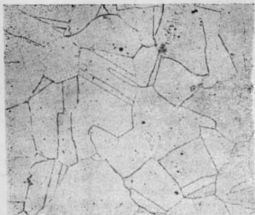
Фиг. 94. Типичная структура ковального материала, содержащего 0,06% углерода, 18,50% хрома и 9,5% никеля
