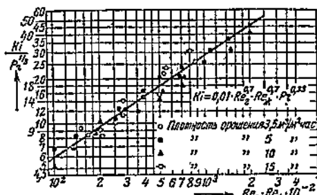
Рис. 88. График Ki = f(Re_0, Re_{ж}, P_r) при охлаждении воздуха водой в скруббере с насадкой. Насадки: кольца Рашига размером 50 \times 50 мм, 35 \times 35 мм и 25 \times 25 мм, кокс размером 40,8 мм и деревянные решетки № 3, уложенные накрест и параллельно.
