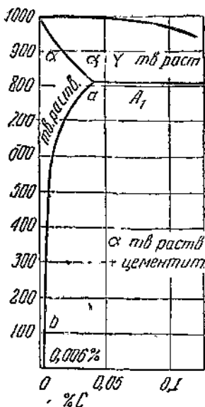
Рис. 2. Растворимость углерода в \alpha -железе
