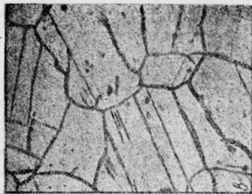
Фиг. 182. Структура стали 18-8 после часового нагрева при 700°. Границы зерен усиленно травятся благодаря обеднению их хромом. \times 500
