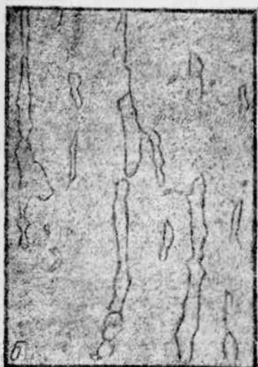
Фиг. 219. Двухфазная аустенито-ферритная структура стали 19-9 с 2,5% Мо после закалки
