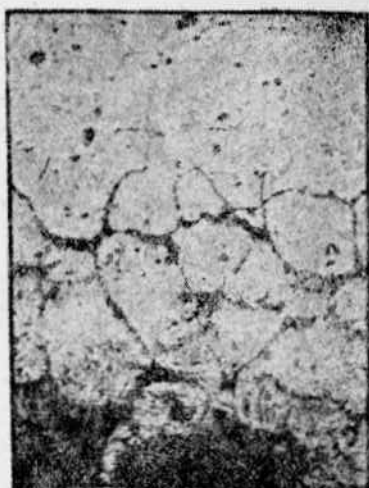
Фиг. 247. Сульфидная коррозия у стали ЭЯЗС после 200-часового нагрева в среде топочных газов с 2—3% SO 2 при 1000°. × 500
