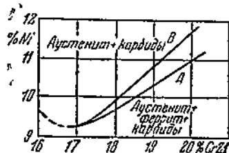
Фиг. 218. Структурная диаграмма для хромоникелевых сталей с содержанием углерода не более 0,08% и при содержании ниобия, в десять раз большем содержания углерода (Френкс):
