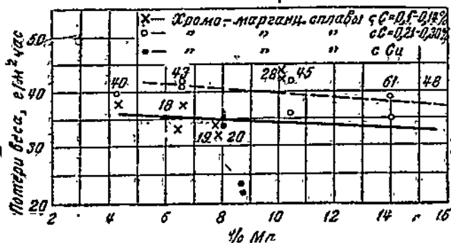
Фиг. 335. Влияние марганца в сталях с 18% Cr на их коррозионную стойкость в 3,6% HCl при комнатной температуре (Шултин)
