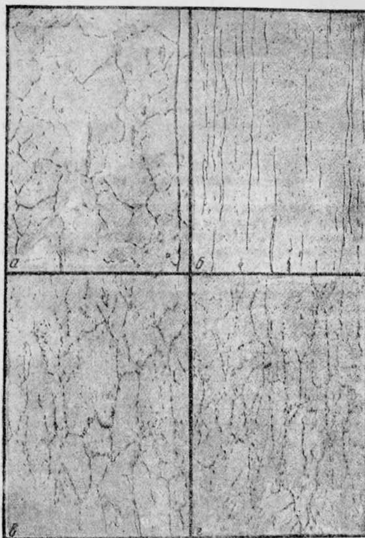
Фиг. 295. Микроструктура сварочных швов стали 18-8 (электролитическое травление в 10%-ной щавелевой кислоте) (Элингс) Сталь с 0,06% С, 18,9% Cr и 9,10% Ni:
