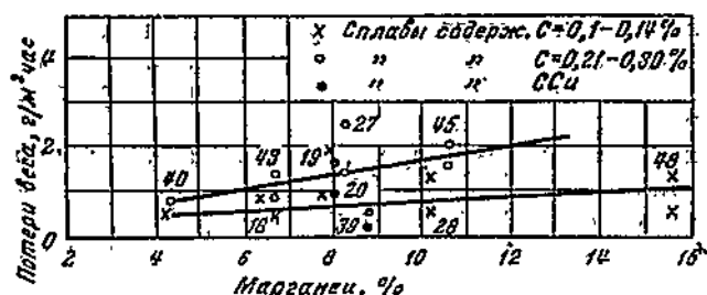
Фиг. 336. Влияние марганца в 18%-ных хромистых сталях на их коррозионную стойкость в 37%-ной кипящей азотной кислоте (Шултин)
