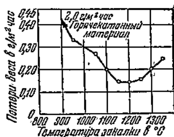
Фиг. 267. Влияние температуры закалки стали 18-8 с 0,14% С на 50%-ную коррозионную стойкость в кипящей азотной кислоте (Шафмайстер)
