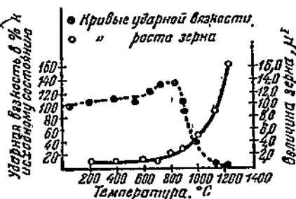
Фиг. 109. Ударная вязкость и рост зерна сплава № 2 при 30-минутной выдержке при разных температурах (Корнилов и Михеев)
