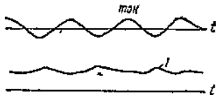
Рис. 71. Характер пульсаций силы света дуговых приборов направленного освещения, питаемых переменным током
