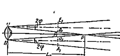
Рис. 79а. Дистанция оформления луча прожектора с дисковым источником света
