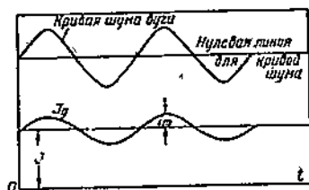
Рис. 73б. Кривая шума дуговой лампы, питаемой постоянным током
