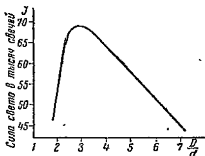
Рис. 43б. Зависимость силы света дуги от диаметра фтиля
