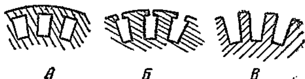
Рис. 12. Форма пазов якоря
