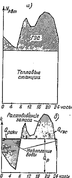
Фиг. 157. Суточное регулирование гидроустановки.
