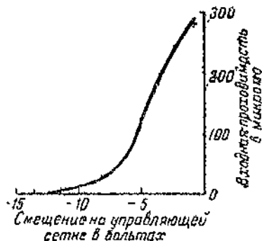
Фиг. 48. Входная проводимость типичного высокочастотного пентода (варимю) при 60 мкГц
