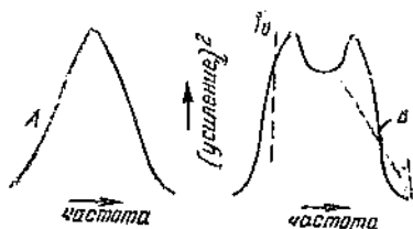
Фиг. 2. Квадраты ординат кривых, приведенных на фиг. 1. f_0 обозначает возможное положение частоты сигнала.
