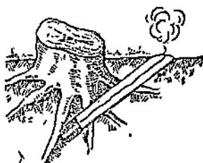
Рис. 6. Корчевка пня взрывным способом.
