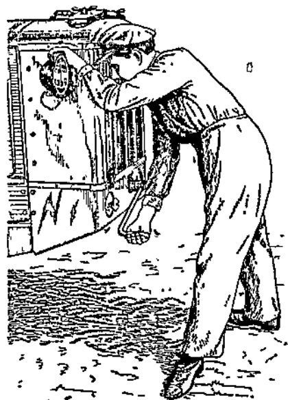
Рис. 3. Заводка двигателя трактора ХТЗ-Т2Г.
