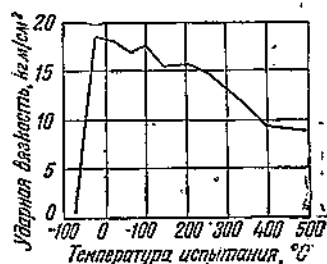
Фиг. 0108 — 3. Ударная вяз- кость углеродистой катаной стали с 0,05% C в зависи- мости от температуры
