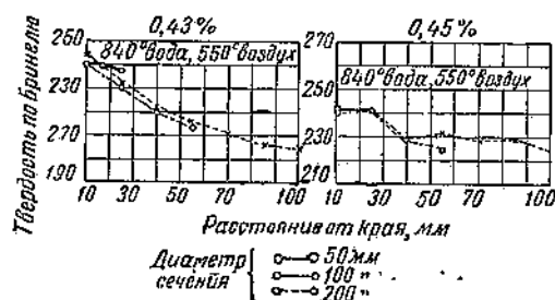
Фиг. 0145 — 15. Твердость закаленных и отпущенных сталей с 0.43—0.45% С в зависимости от сечения
