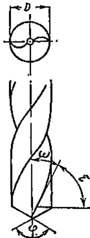
Фиг. 75. Углы спирального сверла.
