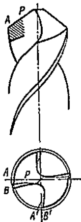
Фиг. 77. Сверло со специальной подточкой.
