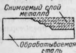
Фиг. 52а. Схема работы четырёхрезцовой державки
