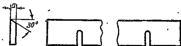
Фиг. 58а. Нож к бесцентровошлифовальному приспособлению
