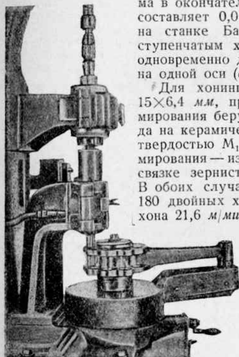
Фиг. 53. Хонингование отверстий для прицепных шатунов.
