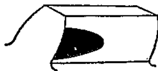
Фиг. 64. Смещенный контакт при перекошенных осях.
