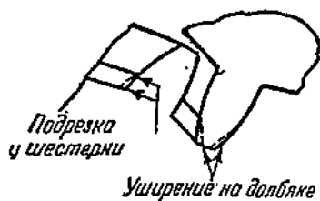
Фиг. 23. Образование подрезки на зубьях шестерен.
