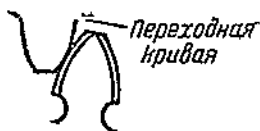
Фиг. 41. Врезание зуба в переходную кривую.
