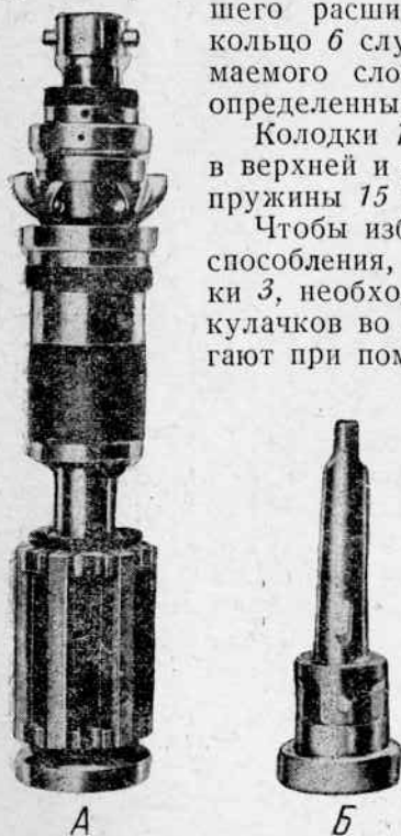
Фиг. 16. А-автоматический хон Микроматик модели АОФ; Б-патрон „Квиклок“.
