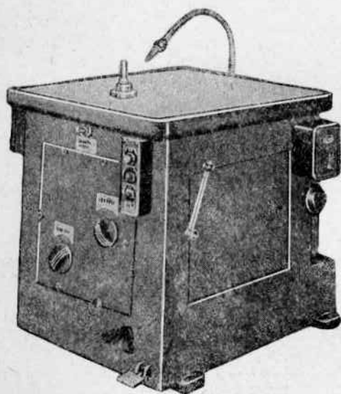
Фиг. 43. Вертикальный одношпиндельный хонинг-станок фирмы Хонинг Иквипмент.
