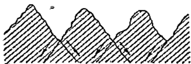
Фиг. 4. Действие коррозии на шероховатой поверхности.
