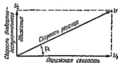
Фиг. 5. Параметры, определяющие скорость резания.
