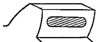
Фиг. 48. Наиболее желательный контакт при сцеплении цилиндрических шестерен.
