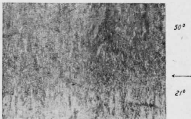
Фиг. 31. Осадок меди из раствора, содержащего 250 \text{ г CuSO}_4 \cdot 7\text{H}_2\text{O} и 7 \text{ г H}_2\text{SO}_4 на 1 \text{ л} . Плотность тока 3 \text{ А/дм}^2 . \times 75
