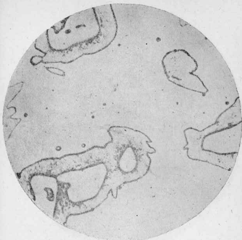
Рис. 59. Микроструктура стали, показанной на рис. 58, после выдержки образца 5 сек., при температуре 745^{\circ}\text{C} ( 1375^{\circ}\text{F} ) и последующей закалке. Видна зона диффузии углерода при образовании аустенита (в данный момент мартенсита); \times 2000 (Vilella).
