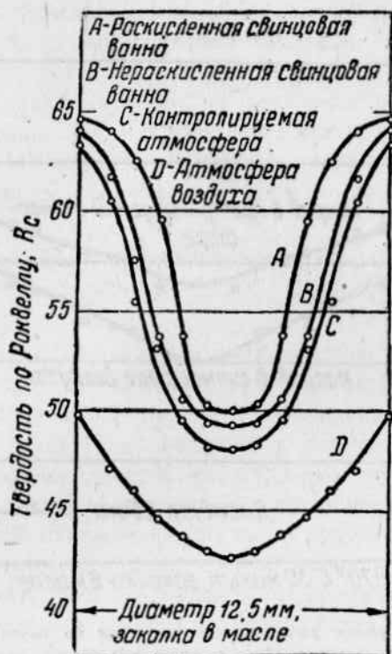
Рис. 139. Диаграмма распределения твердости по сечению цилиндрического закаленного в масле прутка диаметром 12,5 мм в зависимости от окисления поверхности при одинаковых других факторах закалки (см. примечание 43).
