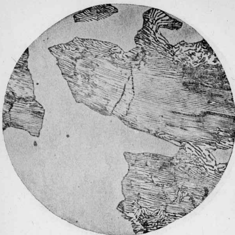
Рис. 17. Превращение аустенита в перлит, зафиксированное в тот момент, когда количество превращенного аустенита составляет 50%; \times 1000 (Vilella).
