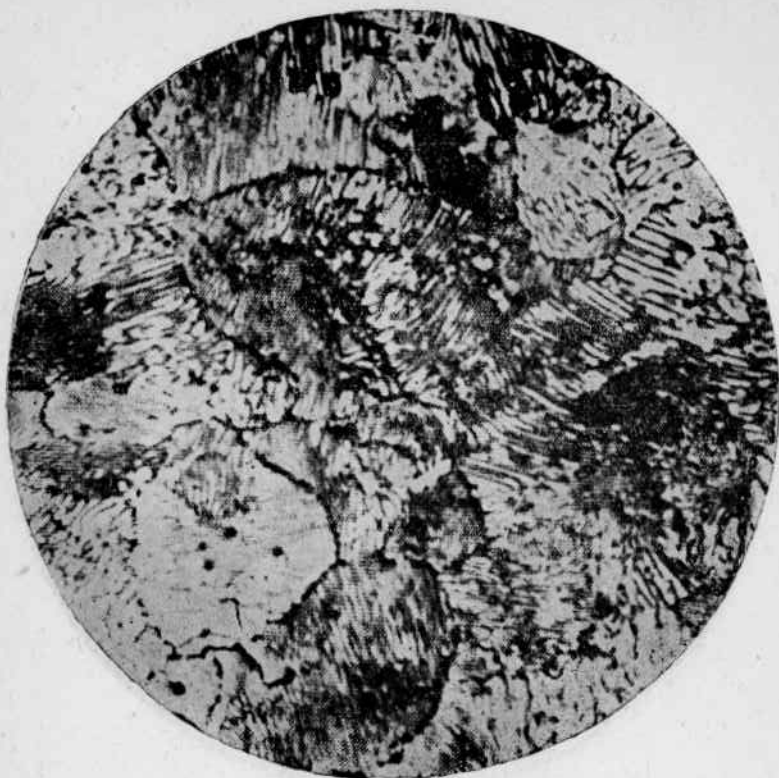
Рис. 23. Тонкопластинчатый перлит, образовавшийся при 650^{\circ}\text{C} ( 1200^{\circ}\text{F} ). Твердость R_c - 33 ; H_B - 319 ; \times 3000 . (Vilella).
