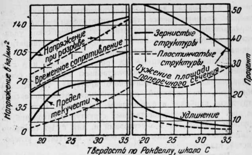
Рис. 28. Влияние структуры на механические свойства аустенитной стали при одинаковой твердости пластинчатых структур и зернистых структур (полученных путем закалки с отпуском).
