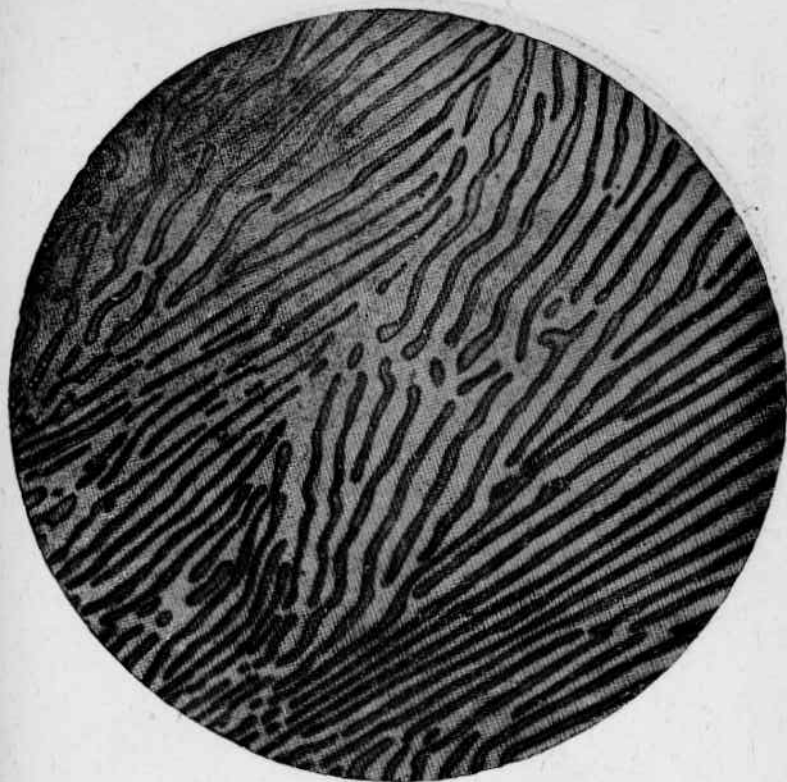
Рис. 20. Грубопластинчатый перлит, образовавшийся при температуре, близкой к 726^{\circ}\text{C} ( 1325^{\circ}\text{F} ). Твердость R_c - 5 , H_B - 170 ; \times 2500 . (Vilella).
