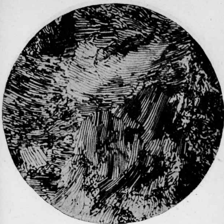
Рис. 22. Среднеламинчатый перлит, образовавшийся при 665^{\circ}\text{C} ( 1225^{\circ}\text{F} ). Твердость R — 30, H_V — 296; \times 2500 . (Viella).
