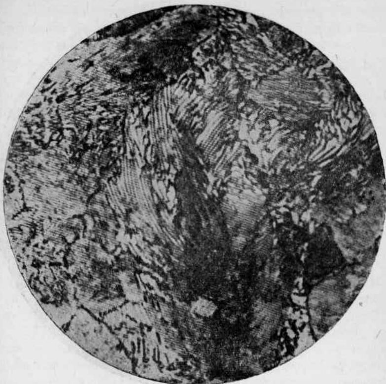
Рис. 24. Тонкопластинчатый перлит, образовавшийся при 595^{\circ}\text{C} ( 1100^{\circ}\text{F} ). Твердость R_c - 40 , H_B - 377 ; \times 3000 . (Vilella).
