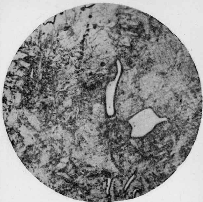
Рис. 61. То же, что на рис. 59 и 60 после выдержки 60 сек. при температуре 745^{\circ} ; \times 2000 (Vilella).
