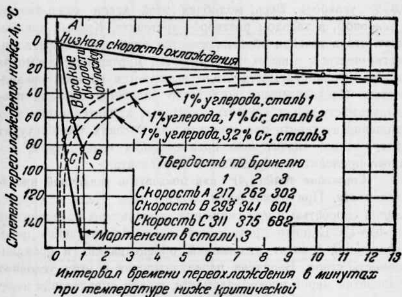
Рис. 107. Влияние одной и той же скорости охлаждения на температуру превращения трех сортов хромистой стали с одинаковым содержанием углерода. На ординате нанесена не температура, а степень переохлаждения. Время в линейной шкале.
