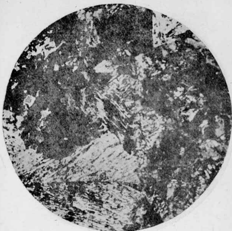
Рис. 30. Типичный вид игольчатой структуры, появившейся при температуре превращения 495^{\circ}\text{C} , несколько ниже температуры максимальной скорости превращения. Наблюдаются следы тонкопластинчатого перлита и бейнит. \times 2500 . (Vilella).
