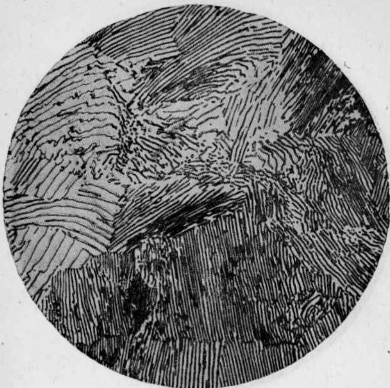
Рис. 19. Тот же процесс превращения, что и на рис. 15—18: весь аустенит превратился в перлит; \times 1000 . (Vilella).
