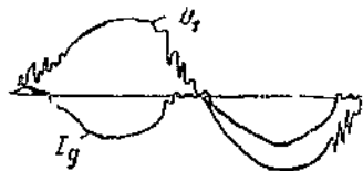
Фиг. 21. Осциллограммы выпрямленного тока I_g и первичного напряжения U_1 трансформатора.
