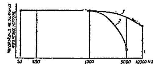
Рис. 169. Частотная характеристика корректирующего элемента, ограничивающего характеристику в области высоких частот
