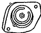
Рис. 86. Переменное сопротивление ПСК в разобранном виде
