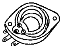
Рис. 86. Переменное сопротивление ПСК в разобранном виде
