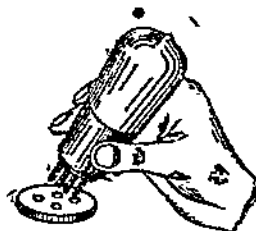
Рис. 4. Способ вставления лампы
