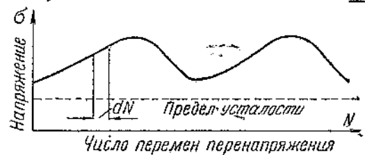
Рис. 6. Схема непрерывного изменения амплитуды напряжений.
