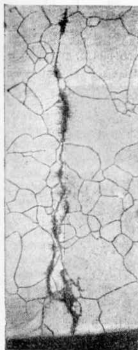
Фиг. 188. Транскристаллитная трещина на образце стали 18% Cr, 8% Ni, 10% W, разрушенном вследствие коррозионной усталости. Раствор (\text{NH}_4)_2\text{SO}_4 \times 100 (Гаф)
