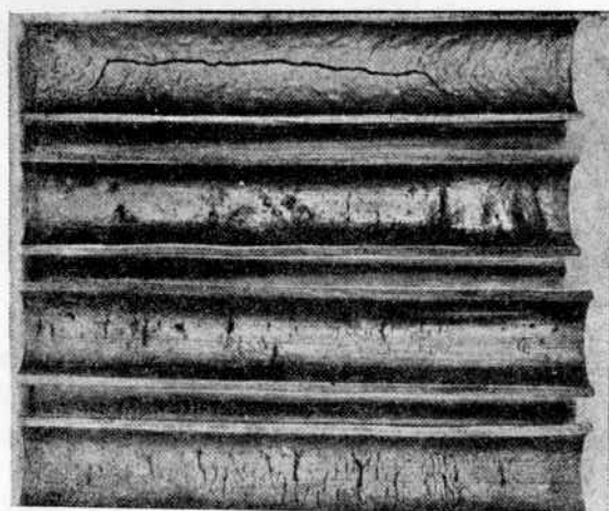
Фиг. 193. Трещины на трубках пароперегревателя, появившиеся вследствие коррозионной усталости
