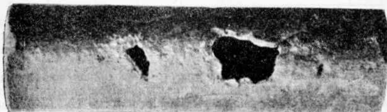
Фиг. 179. Чугунная труба, пострадавшая от коррозии вследствие блуждающих токов (Маас)
