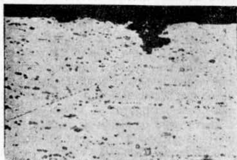
Фиг. 224. Образование питтингов на поверхности алюминиевого сплава через 9 месяцев коррозии в воде. \times 100
