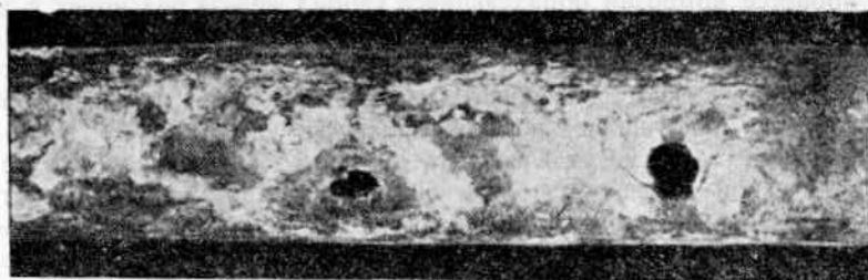
Фиг. 180. Цинковая труба, разрушенная коррозией блуждающими токами (Маас)
