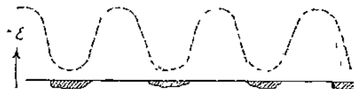
Фиг. 89. Изменение электродного потенциала на поверхности с включениями (Акимов)
