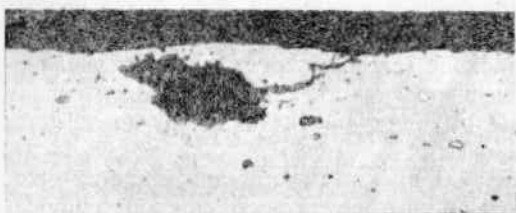
Фиг. 225. Образование коррозионной полости под поверхностью листа из алюминиевого сплава. \times 100
