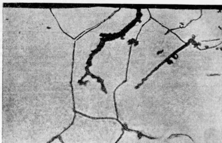
Фиг. 187. Транскристаллитные трещины в мягком железе, развившиеся под влиянием коррозионной усталости в морской воде \times 750 (Гаф)
