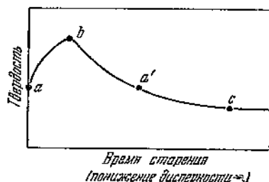
Фиг. 66. Изменение твердости при старении (схема).
