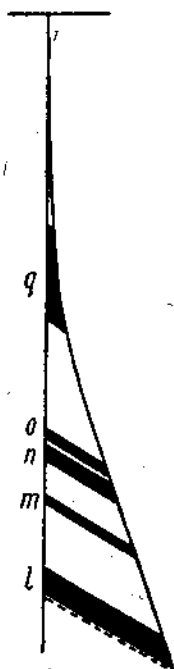
Рис. 122. Неправильная мощность в искривленной скважине.
