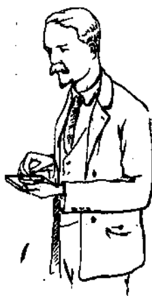
Рис. 32. Положение горного компаса при определении азимута.
