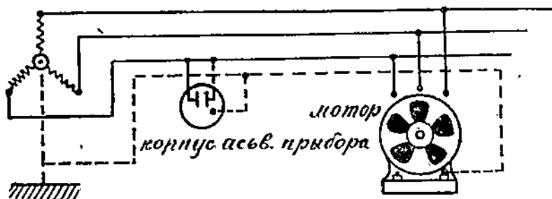
Рыс. 38. Схема ўжывання ахоўнага занулення.
