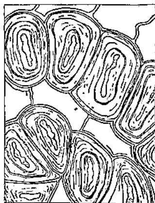
Рис. 13. Поперечный срез пучка волокон пеньки-матерки
