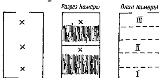
Рис. 76. Схема отбора проб в камерах сушилки
