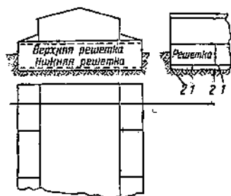
Рис. 30. Схема устройства бельгийского мочильного бака
