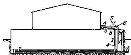
Рис. 31. Схема бельгийского мочильного бака (устройство водоснабжения)
