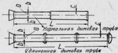
Рис. 162. Дымовые трубы при локомотиве нормальных и удлиненных размеров.
