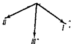
Фиг. 28. Векторная диаграмма напряжения при неправильном соединении катушек по схеме фиг. 27.
