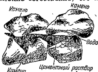
Рис. 92. Сегрегация раствора в пустотах каменной наброски.
