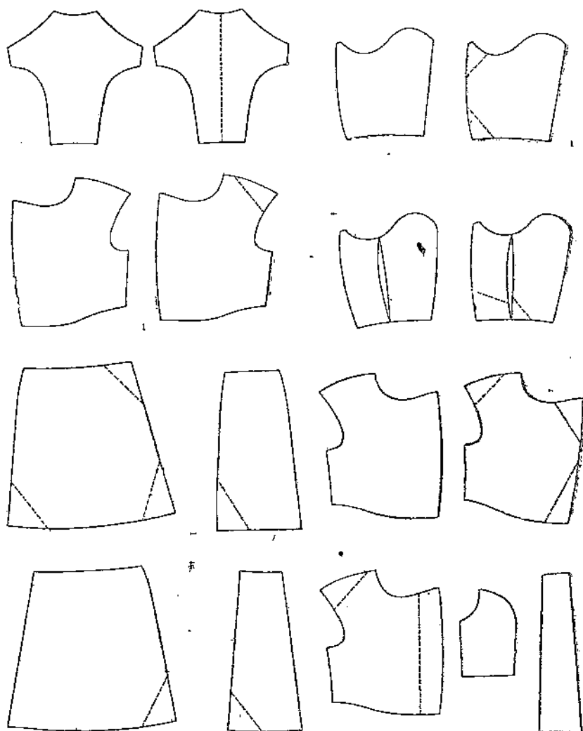
Рис. 8. Чертеж лекал деталей подушубка-бекешки (пунктирные линии означают допуски согласно действующим техническим условиям)
