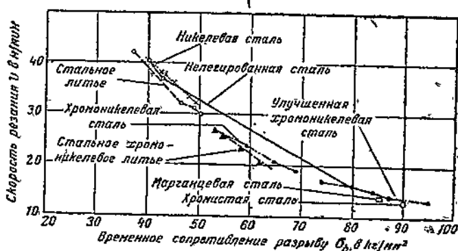
Фиг. 7. Обрабатываемость при точении по данным Аахенской лаборатории (Вомлик и Добрингауз) ( t = 4 мм, s = 2 мм/об, \varphi = 30^\circ , \delta = 73^\circ , T = 60 мин).
