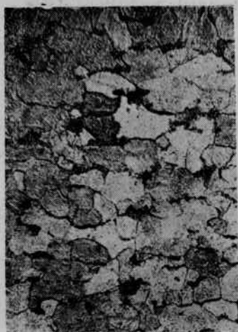
Фиг. 12. Микроструктура стали с содержанием 0,115% углерода после отжига непосредственно перед 1-ой прокаткой; \times 200 .
