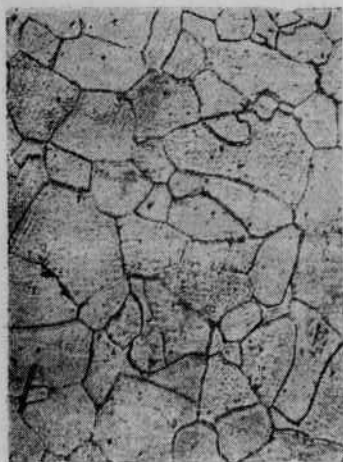
Фиг. 10. Микроструктура стали с содержанием 0,09% углерода после отжига непосредственно перед прокаткой; \times 200 .
