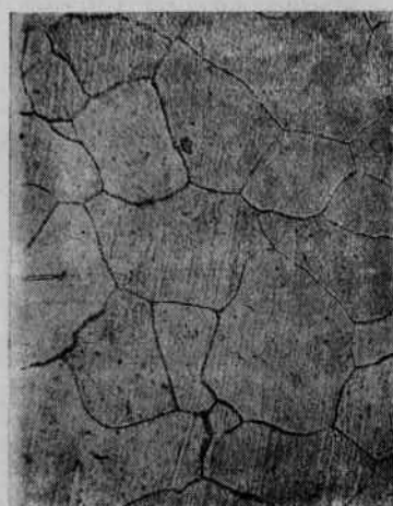
Фиг. 13. Микроструктура стали с содержанием 0,115% углерода после 4-ой прокатки (обжатие за пропуск 18,8%) и последующего пятого отжига; \times 200 .
