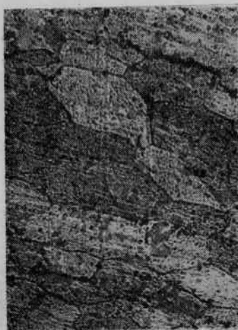
Фиг. 28. Микроструктура неотожженного образца алюминия после 1-ой прокатки. Обжатие 8,3%; \times 200 .
