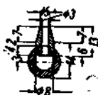
Фиг. 45. Многососковый зонд для отбора проб пара типа ЦКТИ.
