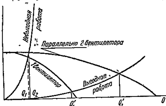
Фиг. 161. Построение суммарной характеристики двух одинаковых параллельно работающих вентиляторов.
