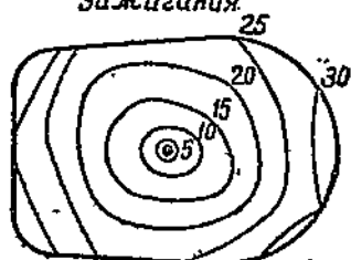
Фиг. 103. Диаграммы распространения пламени при различных положениях свечи.
