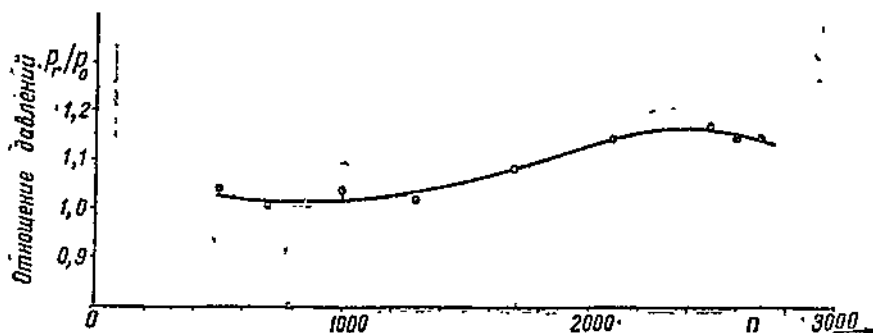
Фиг. 117. Кривая изменения отношения p_r/p_0 в зависимости от числа оборотов при полном дросселе для двигателя «Геркулес» WXB (по опытам автора).
