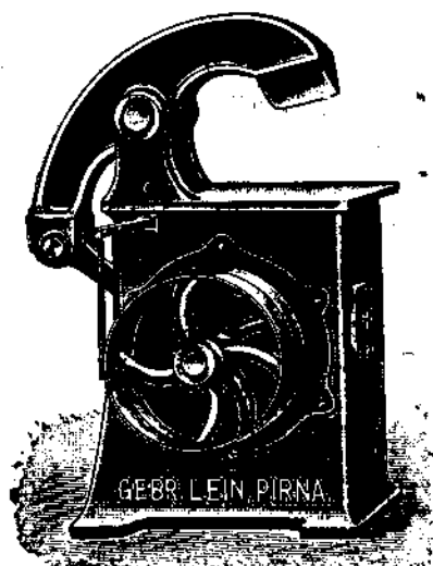
Рис. 35. Колун с балансиром.
